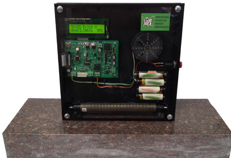
Rys. 10. Przykład pomiaru dużych próbek - tutaj: bloku granitowego (na zdjęciu widoczna jest pierwsza wersja licznika)
