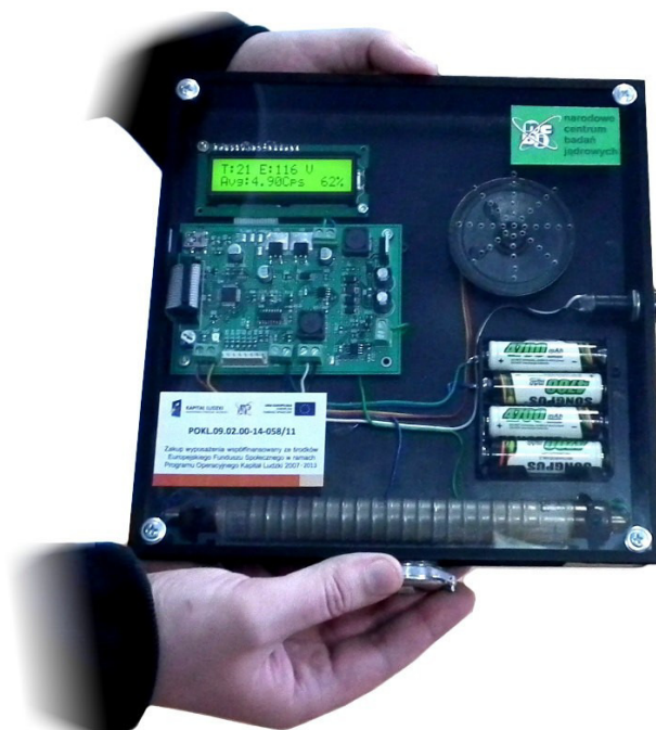
Rys. 11. Przykład pomiaru małych próbek - tutaj: zegarka z farbą rdawą (na zdjęciu widoczna jest pierwsza wersja licznika)
