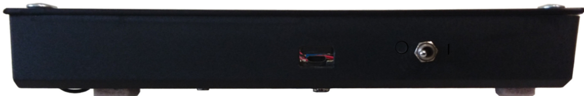
Rys. 2. Widok prawej ścianki licznika (widoczny włacznik/wyłącznik i złącze microUSB)
